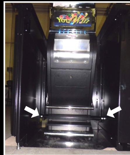
Particolare di ancoraggio della New Slot alla struttura della macchina per evitare che venga sfilata dall'alto.
